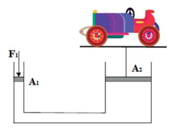
Com base nessas informações, determine a intensidade mínima da força F<sub>1</sub> que deve ser aplicada no pistão da esquerda para manter a plataforma na posição indicada.
