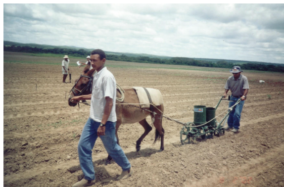
Figura 6: Máquina de arado por tração animal, utilizada na produção de amendoim.
