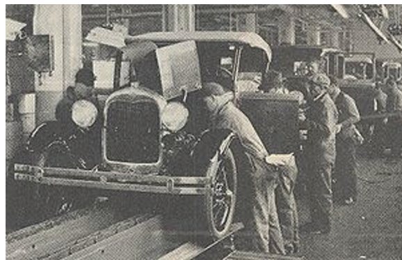
Figura 7: Linha de montagem da Ford. Operários movimentam-se pouco e as peças circulam pelo espaço da indústria.
