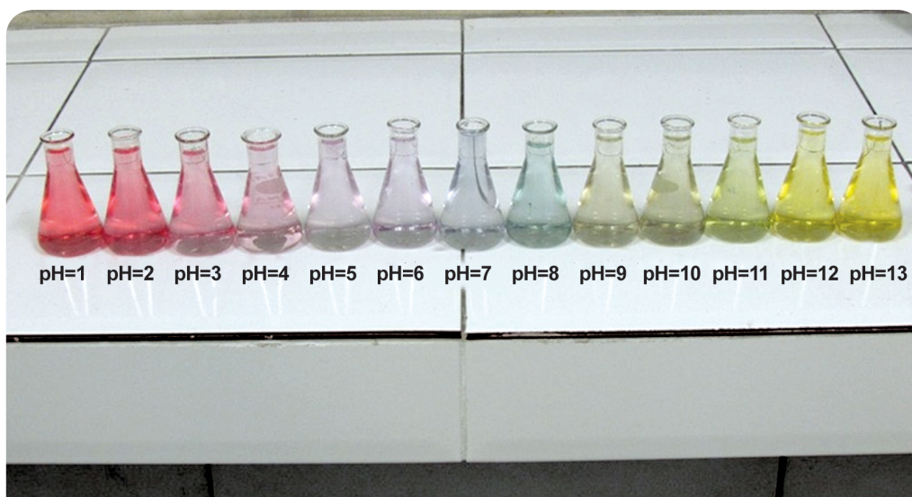
Figura 2: Escala de acidez e basicidade (pH) utilizando o suco de repolho roxo.
