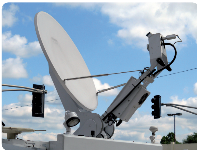
Figura 16: Antena para transmissão via satélite situada no teto de um caminhão de TV.
