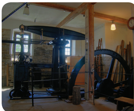
Máquina a vapor, de James Watt, responsável pelo aperfeiçoamento do motor durante a Revolução Industrial na Inglaterra. Patentada em 1800.
