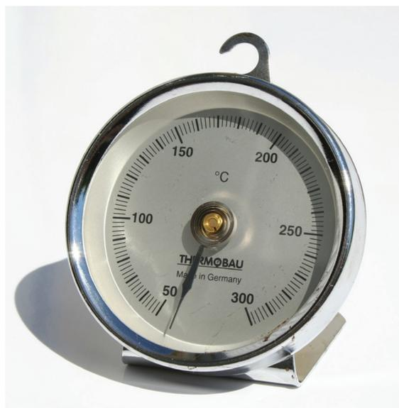
Figura 4: Termômetro de lâmina bimetálica.
