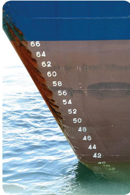
Figura 8: Quando um navio de carga está em sua capacidade máxima, parte de seu casco afunda na água. Quando não há carga a ser transportada, utiliza-se um lastro para que ele afunde na água a mesma quantidade do casco que afundaria se ele estivesse carregado, isso mantém o equilíbrio dele durante a navegação.
