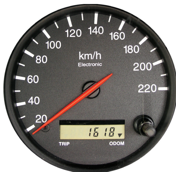
Figura 1: No velocímetro do carro podemos observar duas medições: a velocidade, indicada pelo ponteiro, e a distância percorrida, indicada na numeração da parte de baixo, que é chamada de odômetro.
