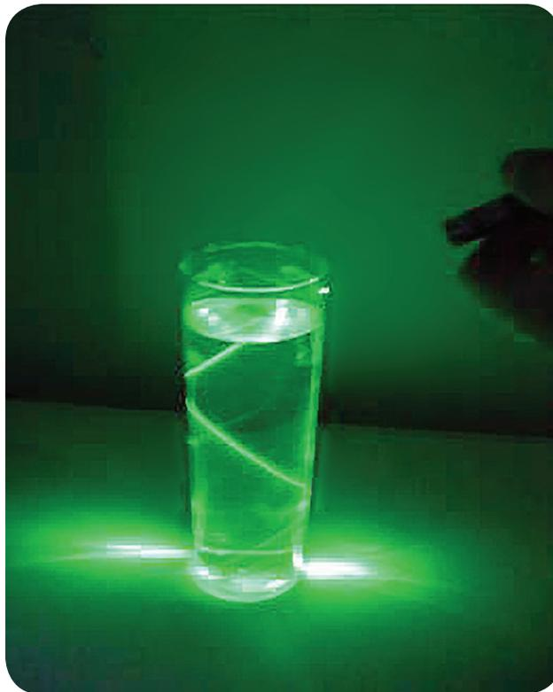
Figura 9: Utilizando um copo com água e leite, conseguimos reproduzir o fenômeno da reflexão total, responsável pelo funcionamento das fibras ópticas.
