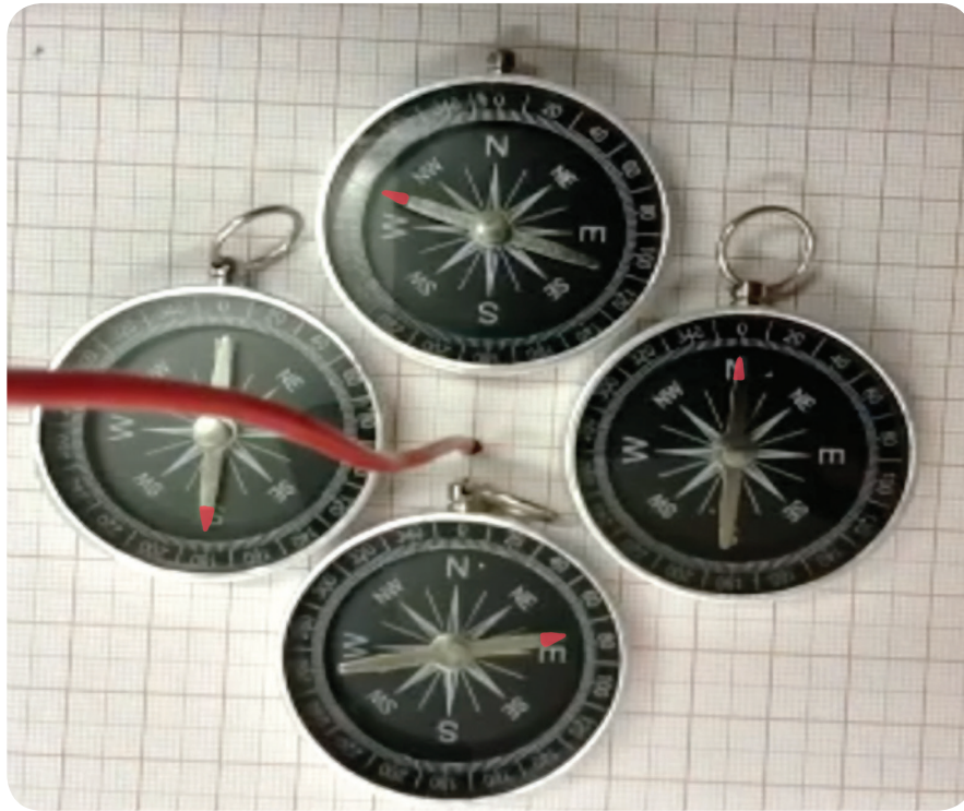
Figura 12: Um fio de cobre é esticado verticalmente. Ligando as extremidades do fio em uma bateria fazemos uma corrente elétrica atravessar o fio. As bússolas da imagem confirmam o que vimos na figura 11.
